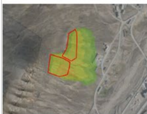
Figur 2: Løsneområder ovenfor Skjæringa og modellering av snøsbred med 0,5 meter snødybde i RAMMS, størrelse S, returperiode 10 år.
