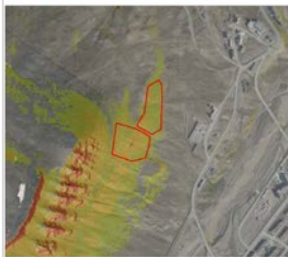
Figur 1: Løsneområder og bratthet ovenfor Skjæringa. Brattheten vises i farger, grønn: 20-35 grader, gul: 35-45 grader, rød: 45-55 grader.
